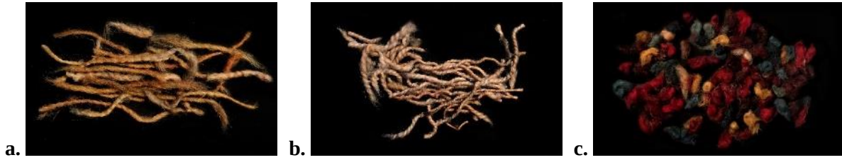
Fotoğraf 2: a. Atkı ipliği numuneleri, b. Çözgü ipliği numuneleri, c. Düğüm ipliği numuneleri
