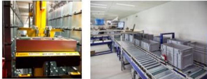
Şekil 8. North Carolina State Üniversitesi James B. Hunt Jr. Kütüphanesi Robotik Kitap Dağıtım Sistemi (John, 2016)
