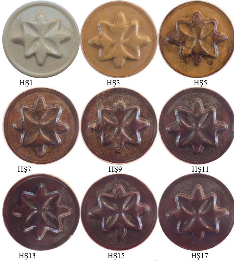
Görsel 5. Şeffaf seramik sırlına Hematit ilave edilerek 1160°C'de pişirilmiş deney plakaları. Elçin Telli kişisel fotoğraf arşivi
