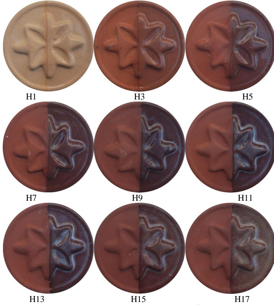
Görsel 3. Seramik döküm çamuruna Hematit ilave edilerek 1160°C'de pişirilmiş deney plakaları. Elçin Telli kişisel fotoğraf arşivi
