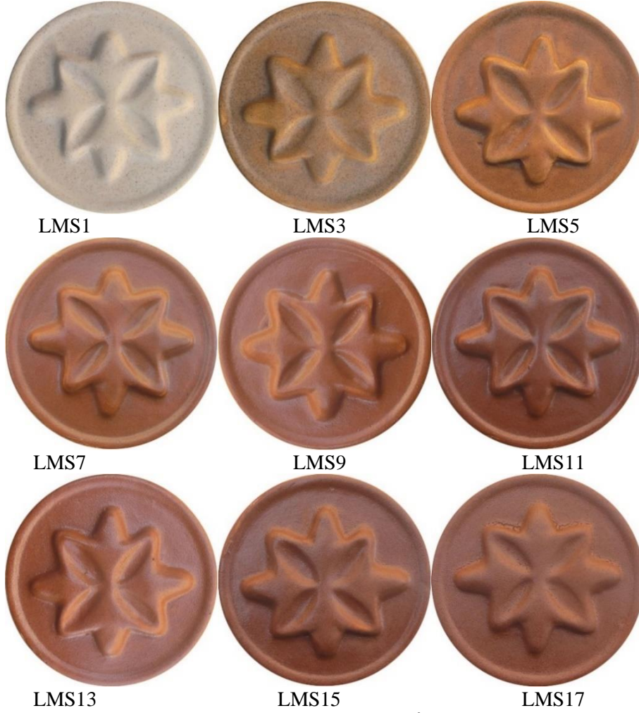
Görsel 8. Mat seramik sırına Limonit ilave edilerek 1160 °C'de pişirilmiş deney plakaları. Elçin Telli kişisel fotoğraf arşivi
