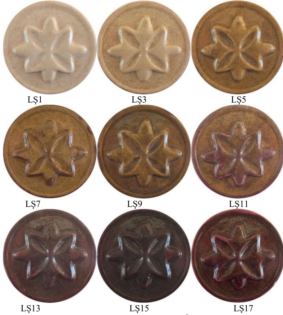
Görsel 7. Şeffaf seramik sırtına Limonit ilave edilerek 1160 0 C'de pişirilmiş deney plakaları. Elçin Telli kişisel fotoğraf arşivi
