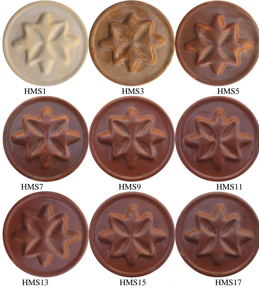
Görsel 6. Mat seramik sırna Hematit ilave edilerek 1160°C'de pişirilmiş deney plakaları. Elçin Telli kişisel fotoğraf arşivi
