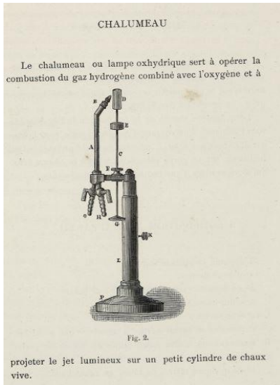
Görsel 3-4: Alev gazı üreten üfleç ile oksijen gazı elde etmek için tasarlanmış sistematik.
